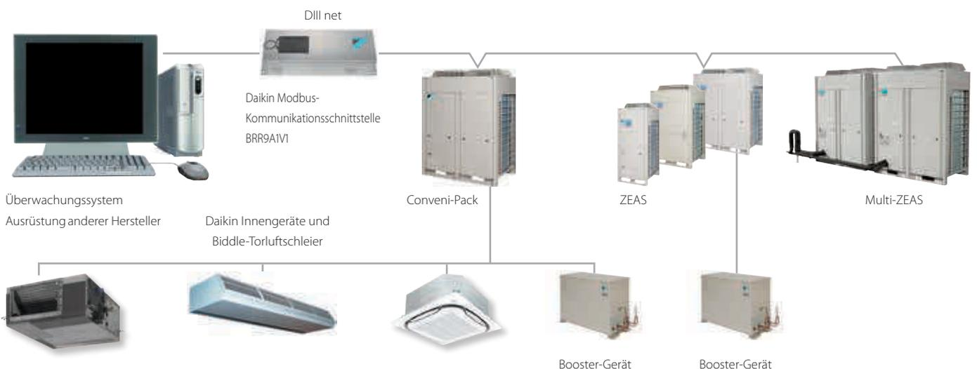
\* Welche Innengeräte und Biddle-Torluftschiefer anschließbar sind, können Sie den Seiten „Conveni-Pack“ in diesem Katalog entnehmen.
