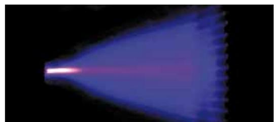
Vom Flash Streamer erzeugte schnelle Elektronen
